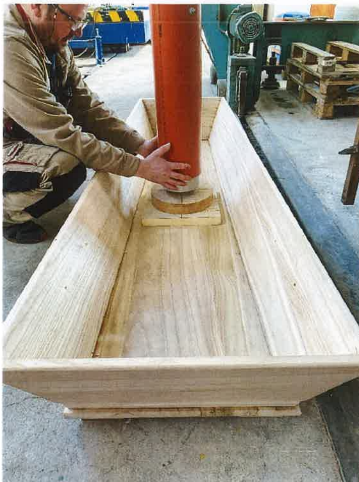
Uspořádání dynamické zatěžovací zkoušky spodního dílu rakve
