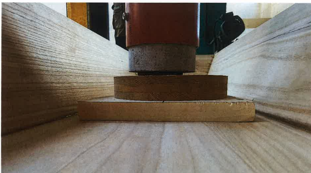
Stav styku dna a boků po provedení zkoušky
